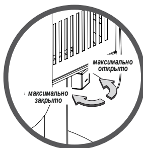
Изображение 18. Регулировка подачи воздуха в печи DEFRO HOME OVAL
